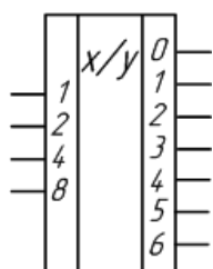
Рисунок 4.6 – Условное графическое обозначение преобразователя кода
